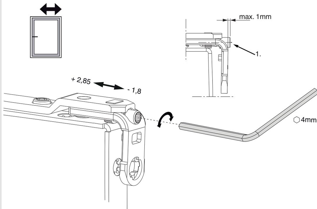
1. Durante l'abbassamento dell'anta assicurarsi che la vite non fuoriesca completamente. La testa della vite deve sporgere al massimo 1 mm!
