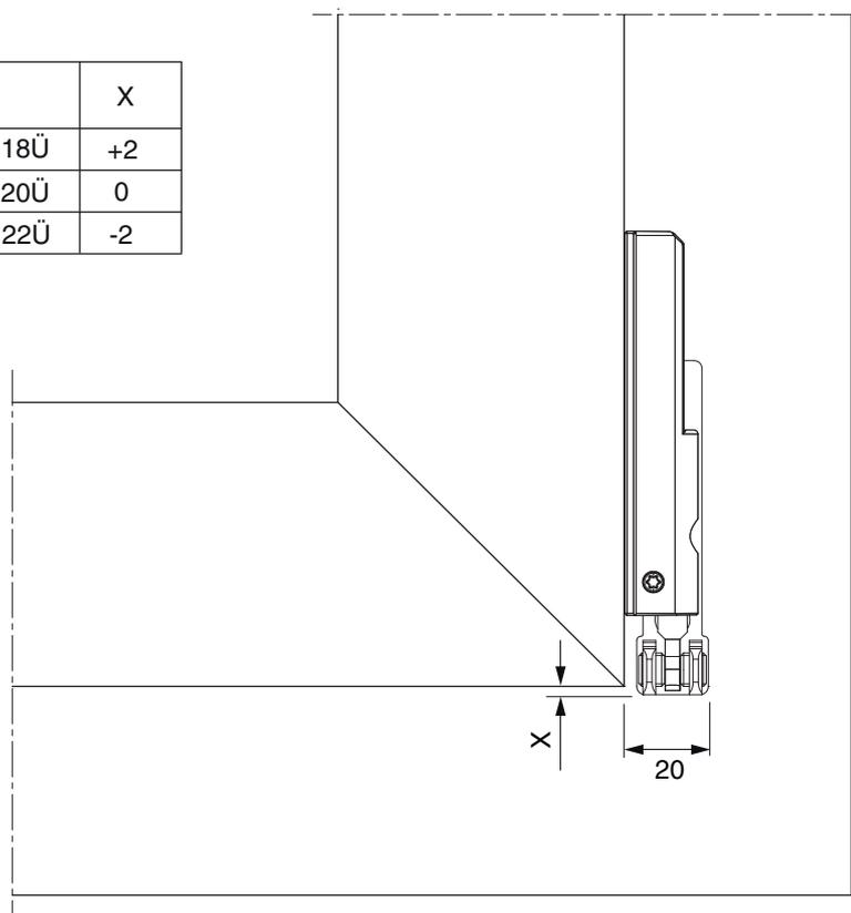
Con l'utilizzo delle coperture lo spazio libero si riduce di 1 mm.
