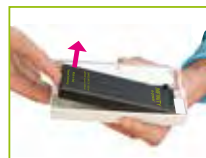
Espulsione manuale della batteria Manual extraction of battery
